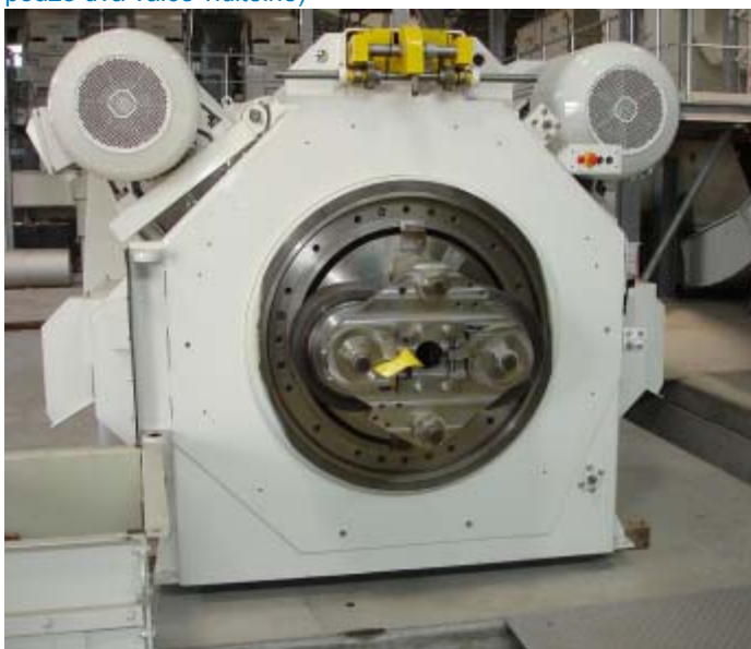
Obrázek 8.7: Lis s kruhovou šablonou (s demontovaným kroužkem šablony, pouze dva válce viditelné)
