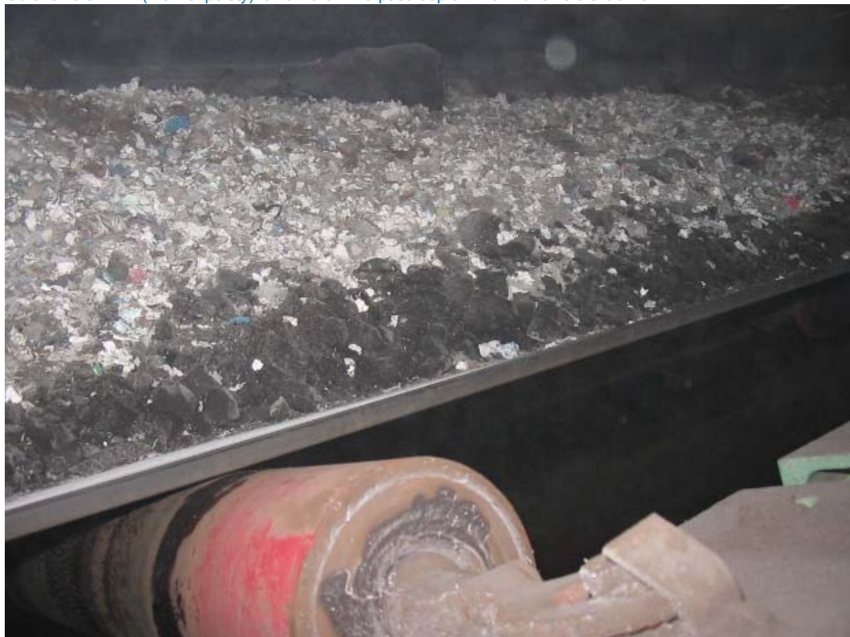
Obrázek 8.5: RDF (měkké pelety) ležící na uhlí na pásu dopravníku v uhelné elektrárně
