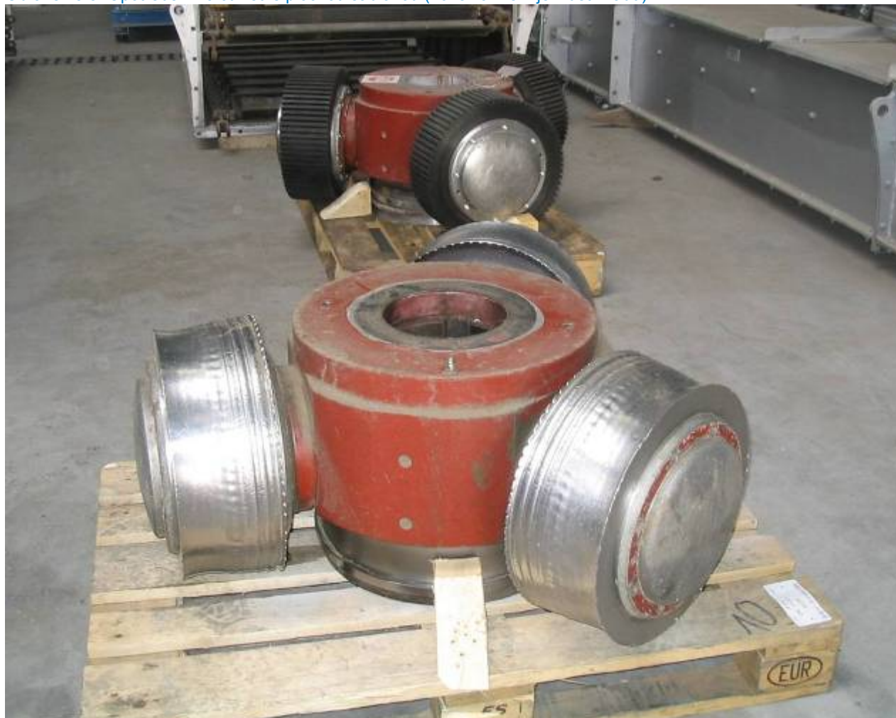
Obrázek 8.8: Opotřebení válců lisu s plochou šablonou (nové zařízení je vidět vzadu)
