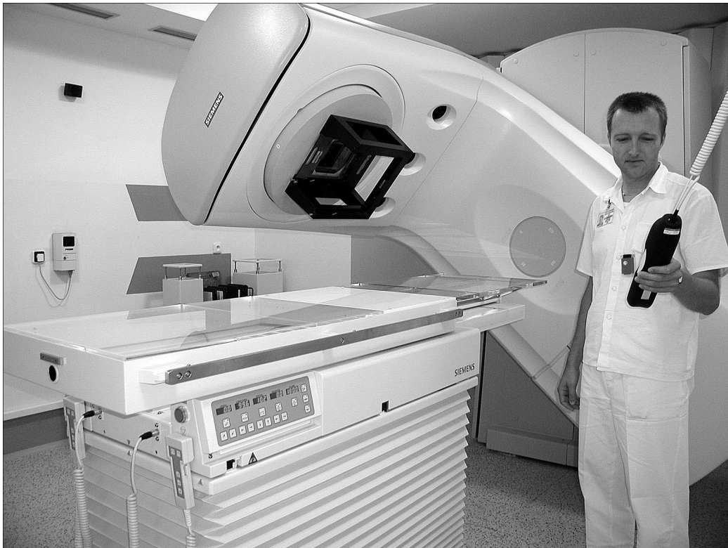
Nový lineární urychlovač z kvalitní v Karlovarském kraji léčbu pacientů s nádorovými onemocněními.
